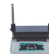
Digitaler Vortexer für mehrere Röhrchen mit Mikroprozessor und bürstenlosem Motor VM25 D
