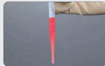
El orificio puede sellarse térmicamente para facilitar el transporte de líquidos.
