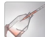
El cuello del matraz inclinado facilita el vertido de líquidos, así como el uso cómodo de pipetas y raspadores celulares.
