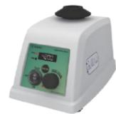
Mezclador vórtex digital con microprocesador y motor sin escobillas VM 28
