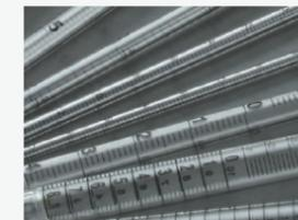
Diseñado con marcas de graduación dobles, lo que garantiza que el volumen de la pipeta pueda identificarse fácilmente.
