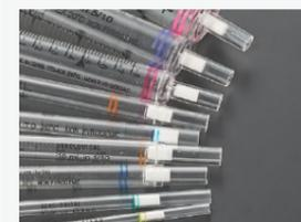
El cabezal de la pipeta está marcada con diferentes códigos de color, para facilitar la identificación del modelo y del rango de la pipeta.
