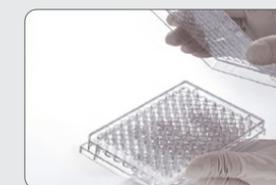
Tapa unidireccional que facilita la sujeción.
