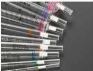
L'embout de la pipette est marqué de différents codes couleur, rendant la gamme et le modèle de pipette faciles à identifier
