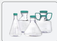
El diseño único del cuello de vaciado del matraz Erlenmeyer de 5 litros evita las salpicaduras de líquido durante el vertido
